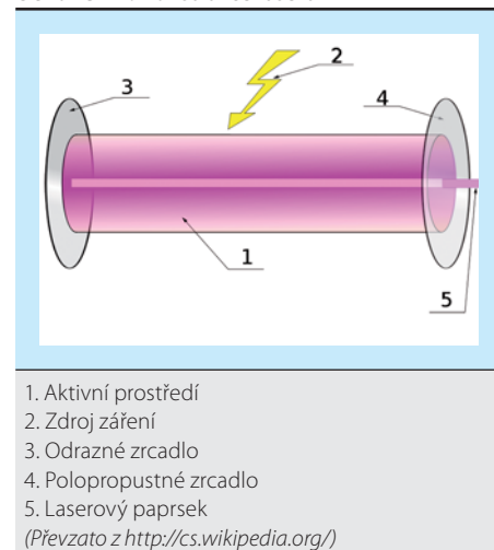
Obrázek 1. Konstrukce laseru
